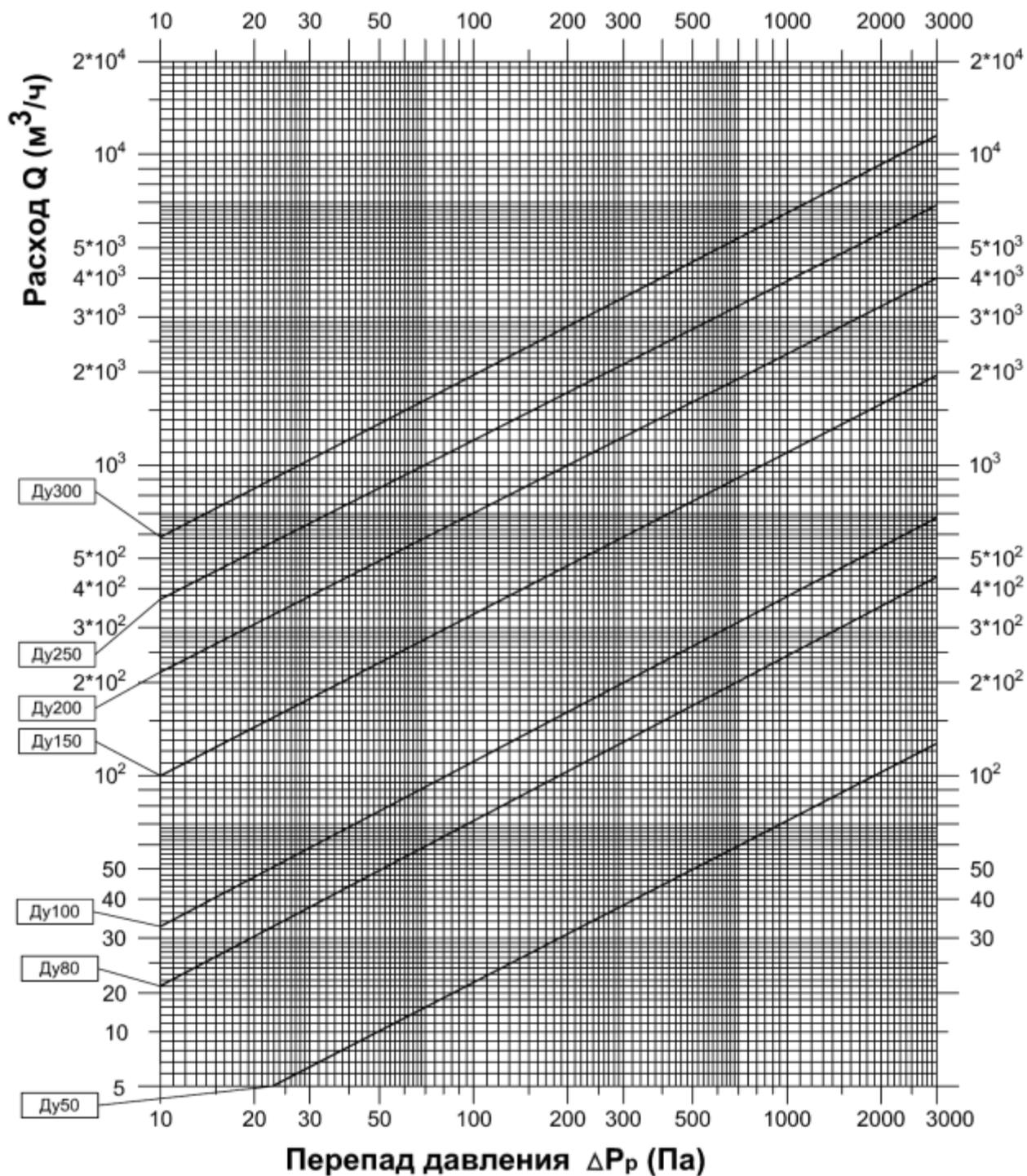
Рисунок А.1 - Зависимость перепада давления на счётчиках газа с различными диаметрами условного прохода от расхода газа. График приведен для газа с плотность  $\rho=1,29$  кг/ $m^3$  при давлении, близком к атмосферному.
