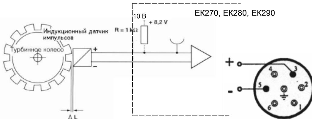
Разъём Binder (вилка) расположен на корпусе датчика А1S.
