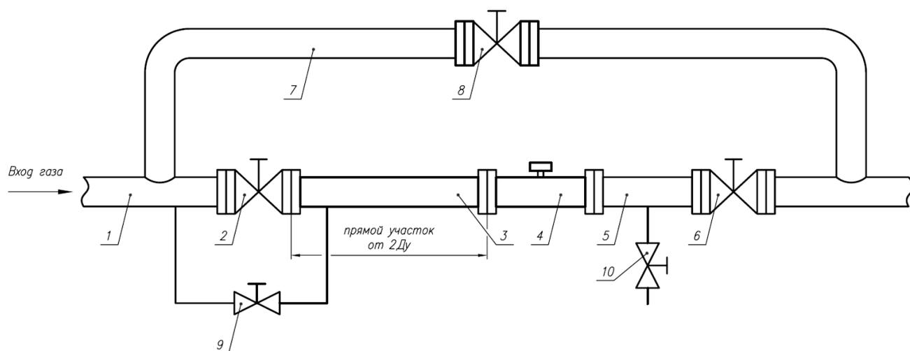
Рисунок Е.2 – Монтаж счетчика с перепускным каналом
