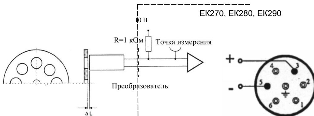
Разъём Binder (вилка) расположен на корпусе датчика А1R.
